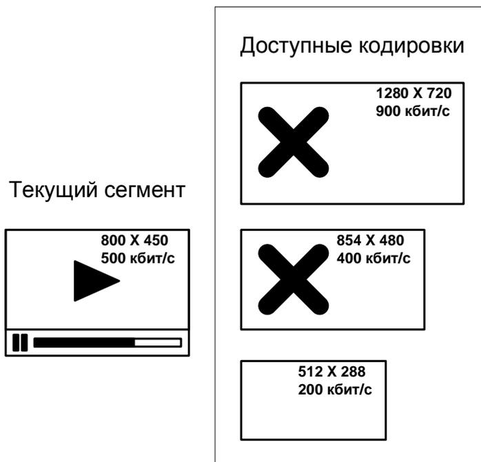
Рисунок 5 – Фильтрация разрешения
