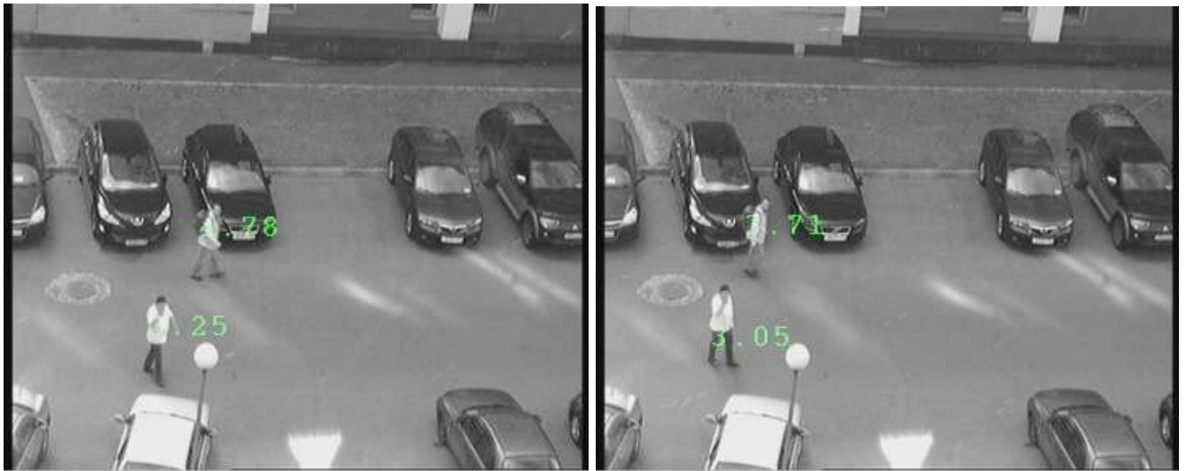
Рис. 7. Оценка скорости движения нарушителя в пределах контролируемого пространства
