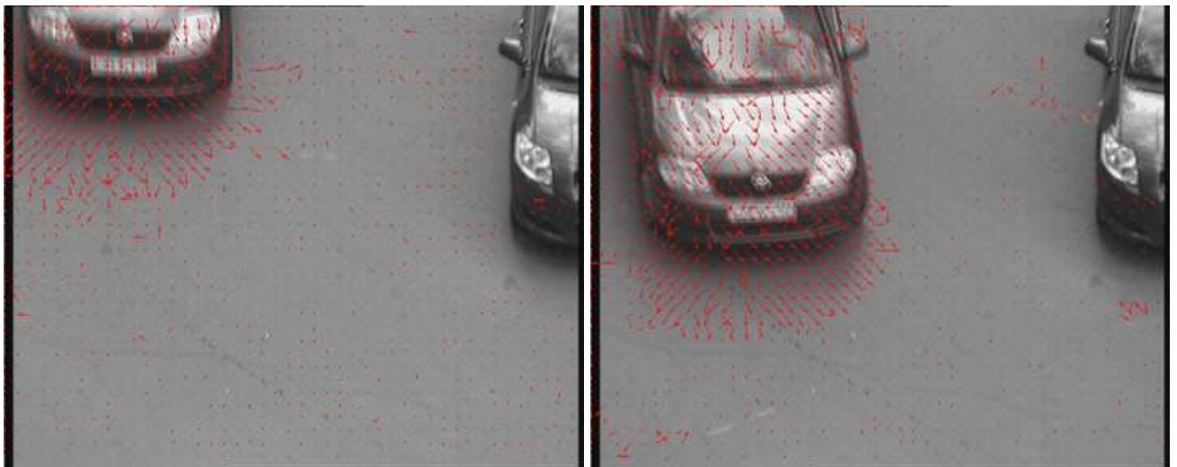
Рис. 8. Результат оценки распределения векторов движения в области нарушения
